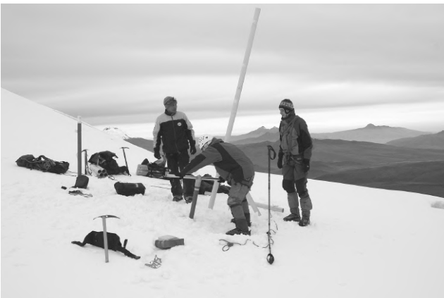
Figura 6 (a sinistra) - Misurazione degli accumuli a 5600 m sul Ghiacciaio 15 dell'Antizana ( 0^{\circ}28'S ). Questo ghiacciaio, studiato dal '95 dall'IRD e dai partner ecuadoriani, è l'unico apparato equatoriale oggetto di osservazioni (bilancio di massa, bilancio idrologico, bilancio energetico). Perde in media quasi 600 mm d'acqua all'anno. (B. Francou).
