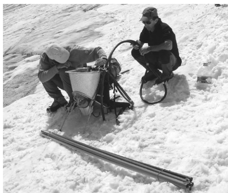
Figura 3 - Posizionamento delle paline di ablazione con la sonda a vapore. (P. René, agosto 2005).
