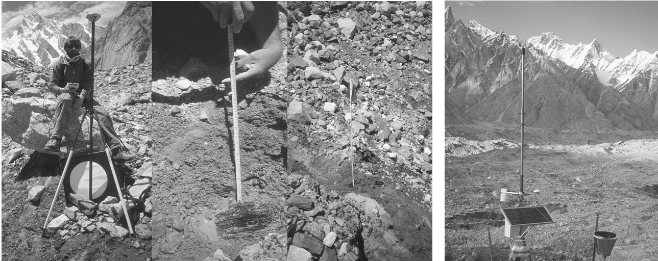
Figura 7 (sinistra) - La stazione meteorologica automatica (AWS) di Urdukas (4020 m) che insieme a quella del Campo Base del K2 ha permesso di realizzare il bilancio energetico e la conseguente ablazione del Baltoro. (C. Mayer).
