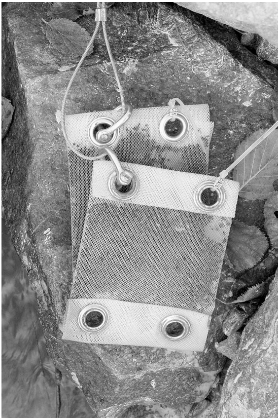
Foto 8: fluorocaptore utilizzato durante la prova con traccianti. (P. Federici).
