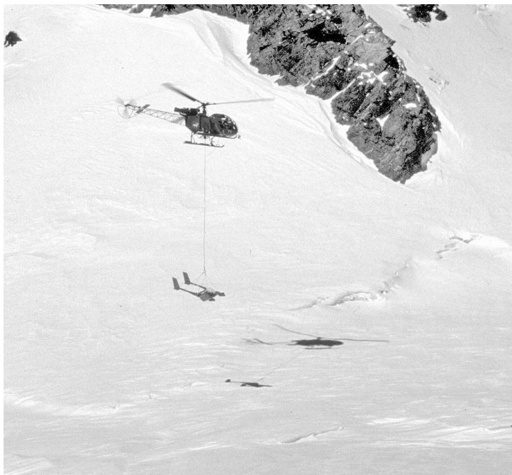
Foto 6: l'elicottero con la struttura utilizzata per sostenere le antenne durante l'esecuzione del rilievo georadar.
